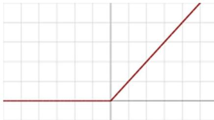
Figure 16 : Exemple d'une fonction d'activation ReLU pour l'intervalle (0; +∞)
