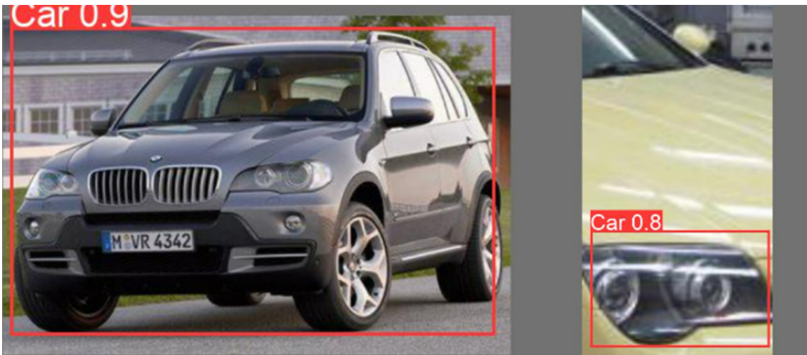
FIGURE 4.1 Prédiction originale de YOLO-V5 sur des images recadrées de la même base de données. YOLO-V5 ne détecte pas les voitures, et détecte à tort les phares comme des voitures.
