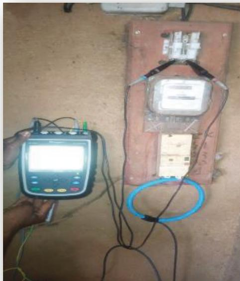
Figure Annexe 21 Câblage de l'analyseur de réseau
