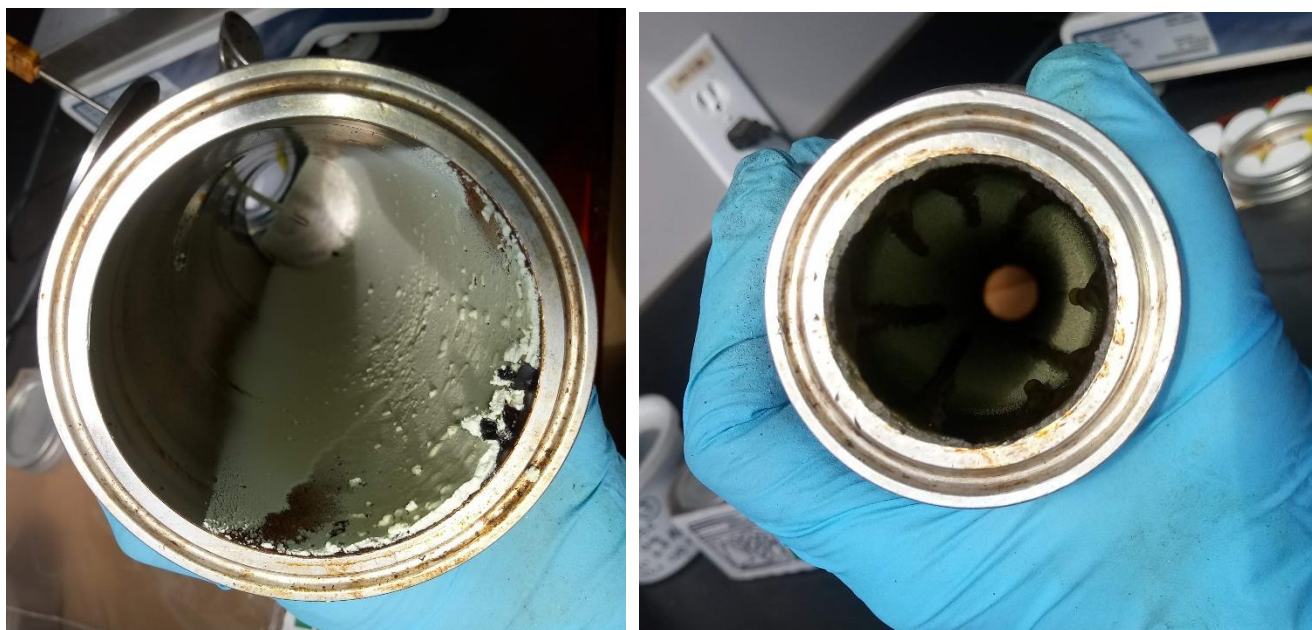
Figure 8. Image du réservoir du condenseur (gauche) et du condenseur (droite) suite à l'essai 5
