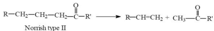
Figure 3.7 Schéma de réaction de type Norrish II qui peut se produire lors de la photo-oxydation des revêtements de peintures. Tirée de : (Yousif et Haddad, 2013)
