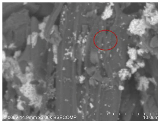
Figure 37 Particule de nickel sphérique vu sur l'essai 7 (20 % Ni)
