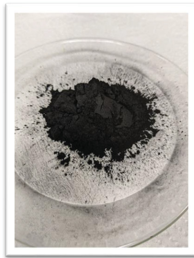
Figure 32 BC4-Cal sélectionné comme support au catalyseur de nickel
