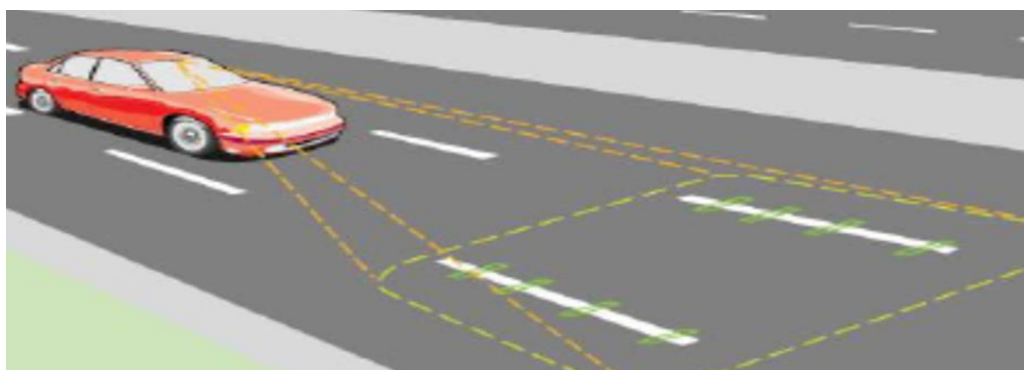
Figure 3 Caméra de vision installée sur le pare-brise pour suivre les marquages au sol.
