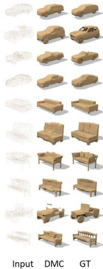
Figure 2.9 : Résultats visuels de Deep Marching Cubes (DMC) à partir d'un nuage de points, adapté de [165]
