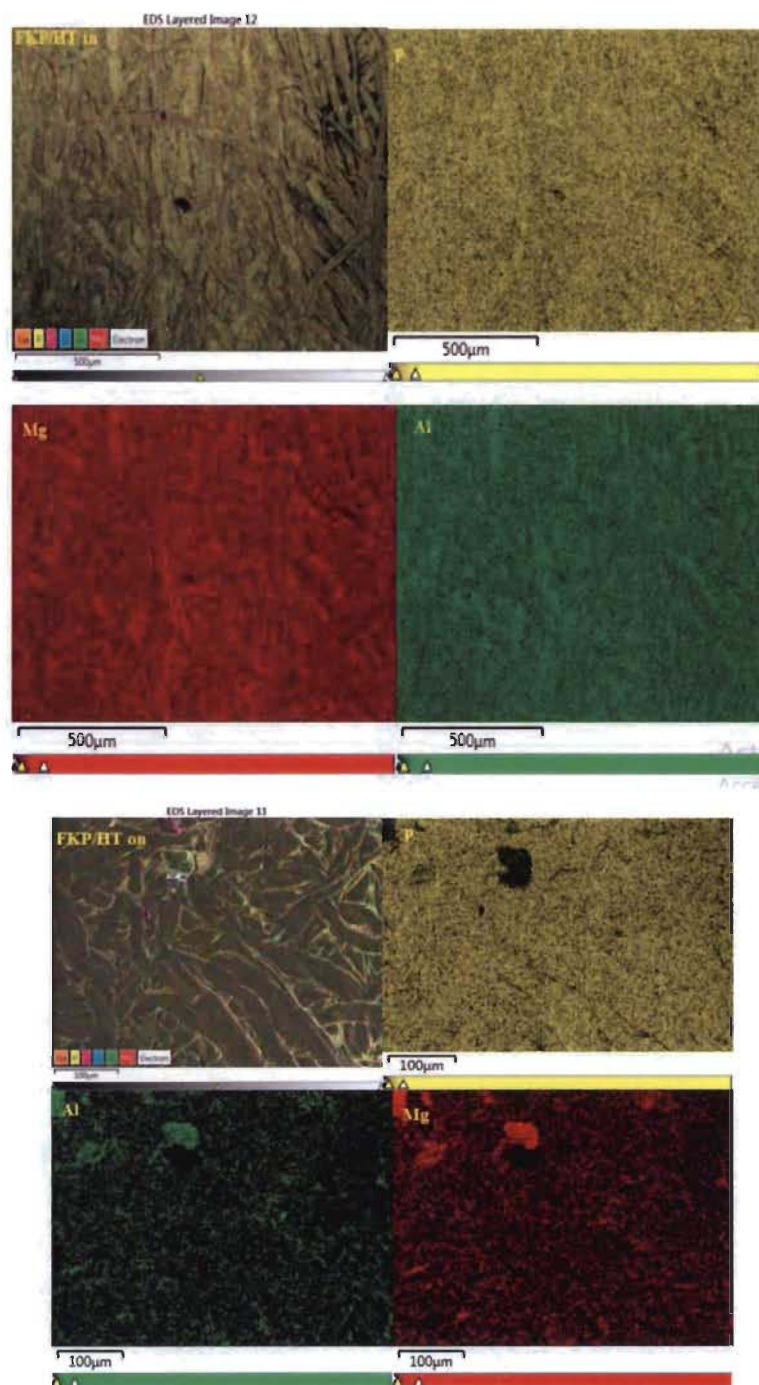
Figure B.2 Répartitions de P, Al et Mg dans les fibres phosphorylées modifiées par les hydrotalcites par synthèse in situ (FKP/HT in) et par synthèse assistée par micro-ondes et ultrason (FKP/HT on).
