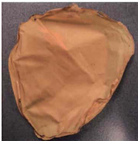
Figure 3.3 : Membrane stabilisée thermiquement et chimiquement
