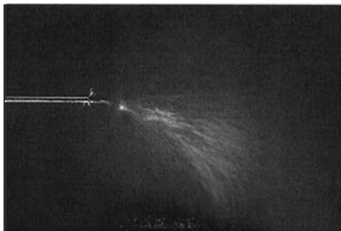
Figure 1.6 : Image du stade initial de l'électrofilage montrant l'instabilité de Rayleigh
