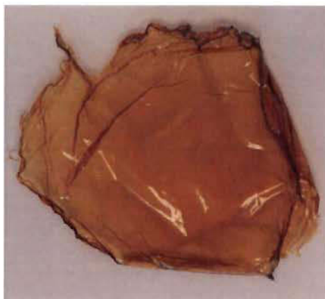
Figure 3.2 : Membrane après la stabilisation chimique
