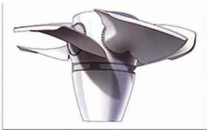
Figure 2.1.2 Turbine ou roue d'eau de type Kaplan ou encore hélice [image de : Hydro-Québec (2021). L'hydroélectricité - Turbines. http://www.hydroquebec.com/comprendre/hydroelectricite/types-turbines.html ].
