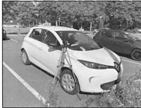
Fig. II.29 : Test du sous-système CVCA en extérieur en mode climatisation.
