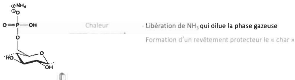
Figure 1.9 : Réaction de la décomposition thermique des fibres phosphorylées
