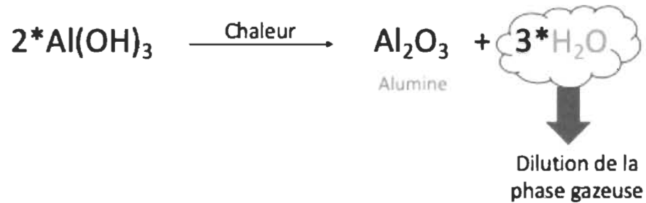
Figure 1.7 : Réaction de la décomposition thermique de l'ATH
