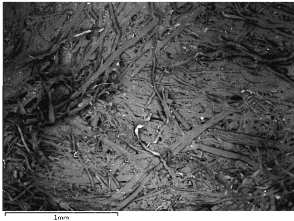
Figure 3.3 : Image MEB de pâte OCC non modifiée
