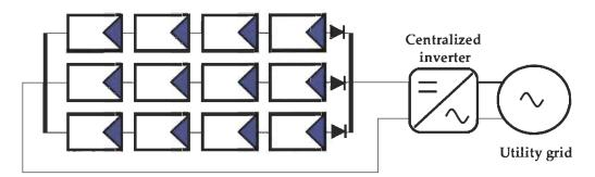
Figure 3.3 Topologie d'onduleur central [26]
