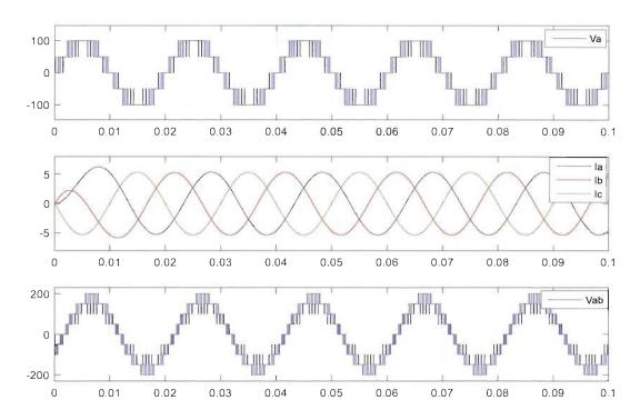
Figure 4.23 Forme des signaux de l'onduleur CHB 5-niveaux
