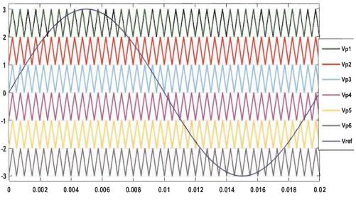
Figure 3.15 Forme d'onde des signaux PD pour 7 niveaux
