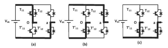
Figure 3.13 : Séquences de fonctionnement d'un bras d'onduleur trois niveaux en cascade [30]
