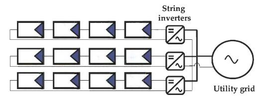
Figure 3.4 Topologie d'onduleur string [26]
