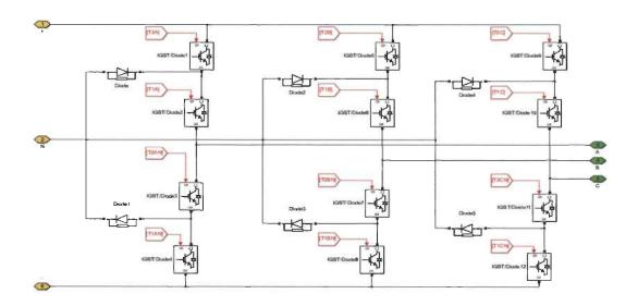
Figure 4.4 Modèle développé d'onduleur NPC 3-niveaux
