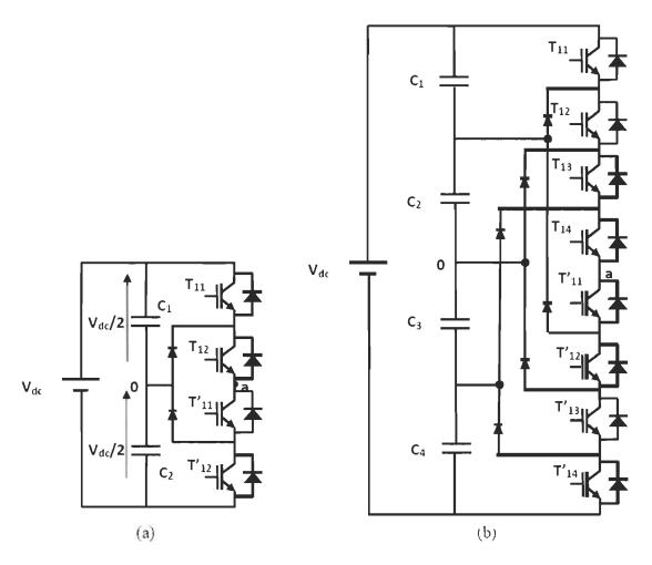
Figure 3.9 Circuit d'une phase d'un onduleur NPC.
