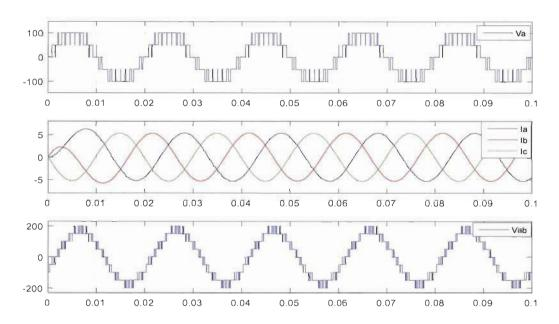
Figure 4.19 Forme des signaux de l'onduleur NPC 5-niveaux
