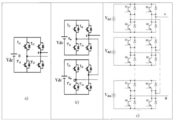
Figure 3.12 : Circuit d'une phase d'un onduleur en pont H cascadé a) à trois niveaux b) à cinq niveaux et c) à n niveaux [30]
