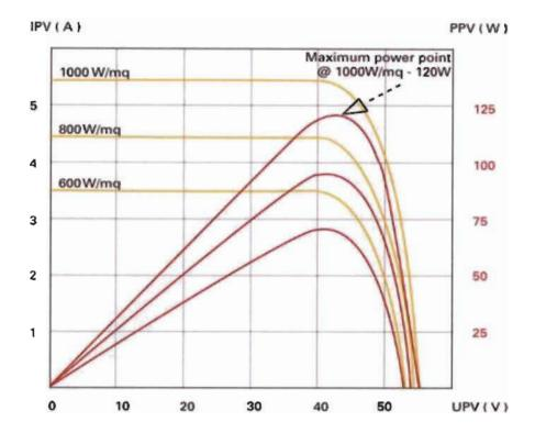
Figure 2.4. Caractéristique de puissance maximum [17]
