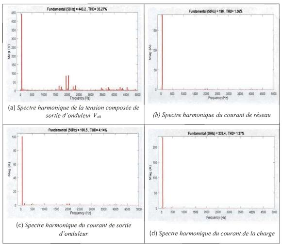
Figure 4.50 Spectres harmoniques des signaux de NPC 5-niveaux
