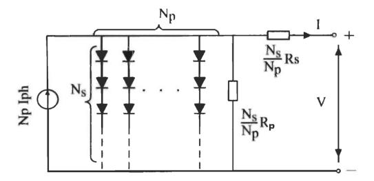
Figure 1.8 Le circuit équivalent du module PV [11]
