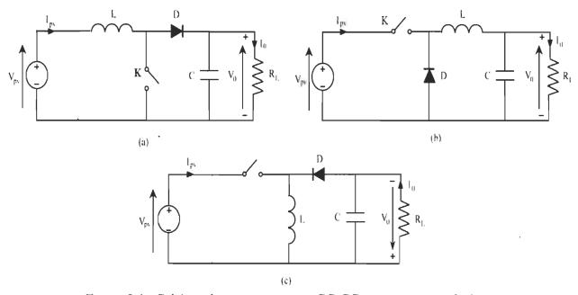
Figure 2.1 : Schéma des convertisseurs CC-CC couramment utilisés
