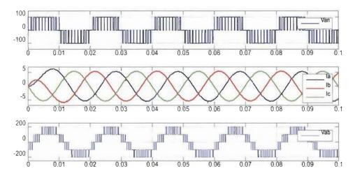
Figure 4.7 Forme des signaux de l'onduleur NPC 3-niveaux
