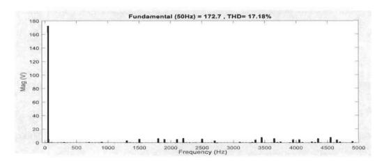
Figure 4.21 Spectre harmonique de la tension  $V_{clb}$  de NPC 5-niveaux
