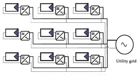
Figure 3.6 Topologie d'onduleur modulaire [26]
