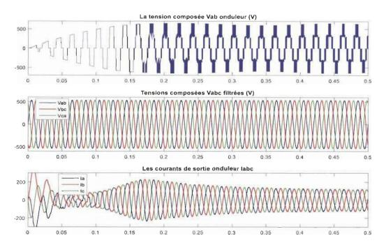
Figure 4.33 Forme des signaux de l'onduleur NPC 3-niveaux connecté au réseau
