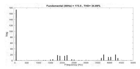
Figure 4.9 Spectre harmonique de la tension  $V_{ab}$  de NPC 3-niveaux
