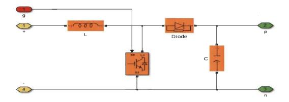
Figure 4.32 : Schéma du hacheur élévateur (Boost)
