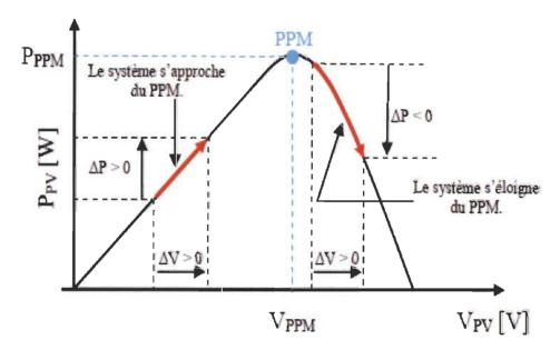
Figure 2.5. Caractéristique de fonctionnement de la méthode P&O [22]
