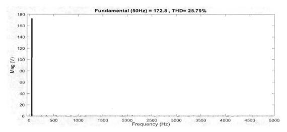
Figure 4.29 : Spectre harmonique la tension  $V_{ab}$  de FC 5-niveaux
