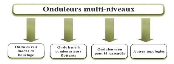
Figure 3.8 Différentes topologies des onduleurs multi-niveaux [31]
