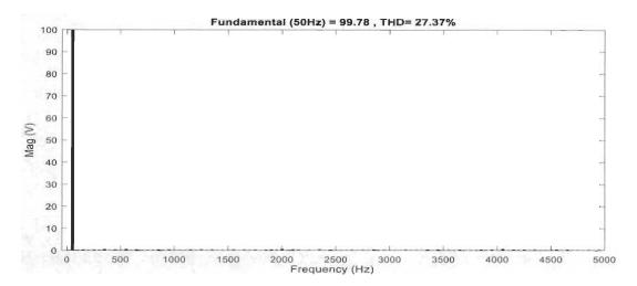
Figure 4.28 : Spectre harmonique de la tension  $V_{con}$  de FC 5-niveaux
