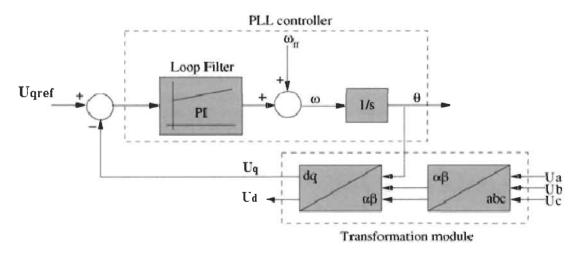
Figure 3.19 Schéma de régulation de la PLL [41]
