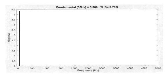
Figure 4.26 : Spectre harmonique du courant de charge de CHB 5-niveaux
