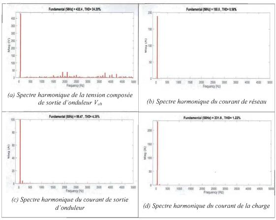
Figure 4.44 Spectres harmoniques des signaux de NPC 5-niveaux
