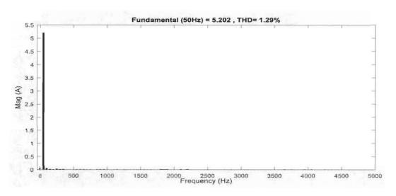
Figure 4.14 : Spectre harmonique du courant de charge de CHB 3-niveaux
