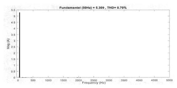
Figure 4.30 : Spectre harmonique du courant  $I_a$  de FC 5-niveaux
