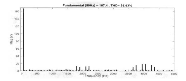
Figure 4.13 : Spectre harmonique de la tension  $V_{ah}$  de CHB 3-niveaux
