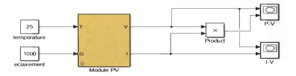
Figure 4.1: Bloc du module Poly ELYSUN dans Simulink
