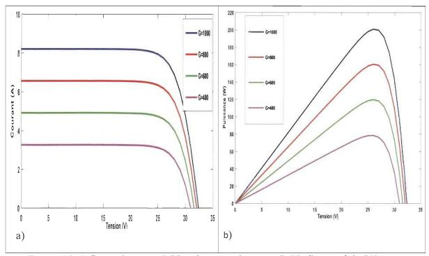
Figure 4.2 a) Caractéristique I (V) et b) caractéristique P (V) d'un module PV pour différentes valeurs de l'éclairement
