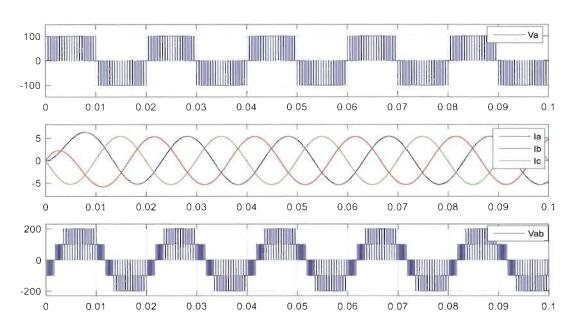
Figure 4.15 Forme des signaux de l'onduleur FC 3-niveaux
