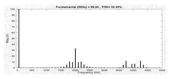
Figure 4.16 : Spectre harmonique de la tension  $V_{an}$  de FC 3-niveaux
