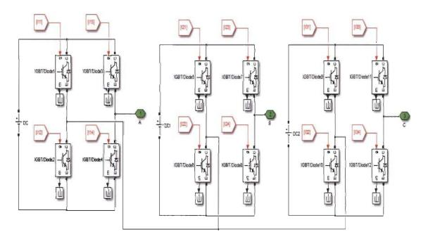
Figure 4.6 Modèle développé d'onduleur CHB à trois niveaux
