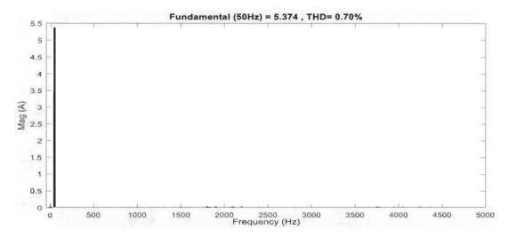
Figure 4.18 : Spectre harmonique du courant la de FC 3-niveaux
