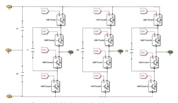
Figure 4.5 Modèle développé d'onduleur FC à trois niveaux
