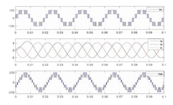
Figure 4.27: Forme des signaux de l'onduleur FC 5-niveaux
