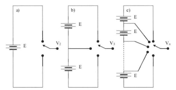
Figure 3.7 Onduleur à niveaux multiples :
