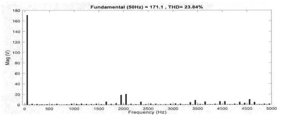
Figure 4.25 : Spectre harmonique de la tension  $V_{ab}$  de CHB 5-niveaux
