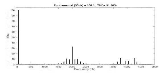
Figure 4.8 Spectre harmonique de la tension  $V_{an}$  de NPC 3-niveaux
