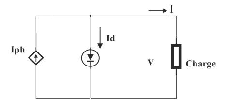
Figure 1.6 Schéma équivalent d'une cellule photovoltaïque idéale [9]
