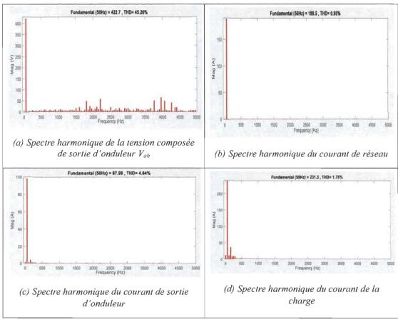
Figure 4.35 Spectres harmoniques des signaux de NPC 3-niveaux
