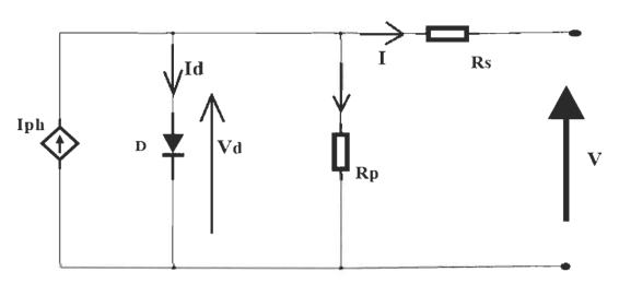
Figure 1.7. Schéma équivalent d'une cellule photovoltaïque idéale [10]
