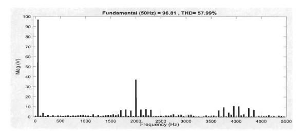
Figure 4.12 : Spectre harmonique du la tension  $V_{an}$  de CHB 3-niveaux
