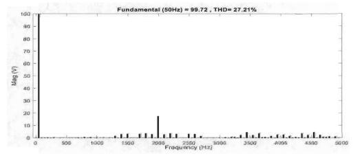
Figure 4.20 Spectre harmonique de la tension V<sub>un</sub> de NPC 5-niveaux
