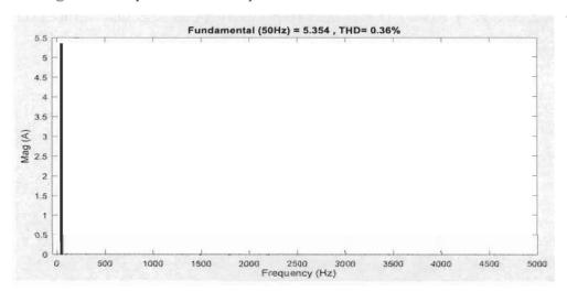
Figure 4.22 Spectre harmonique du courant I<sub>a</sub> de NPC 5-niveaux
