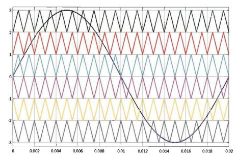
Figure 3.16 Forme d'onde des signaux POD pour 7 niveaux
