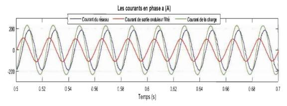
Figure 4.34 Forme des courants de NPC 3-niveaux
