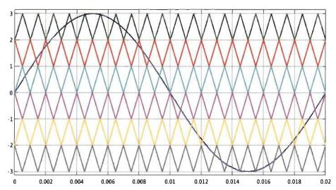
Figure 3.17 Forme d'onde des signaux APOD pour 7 niveaux
