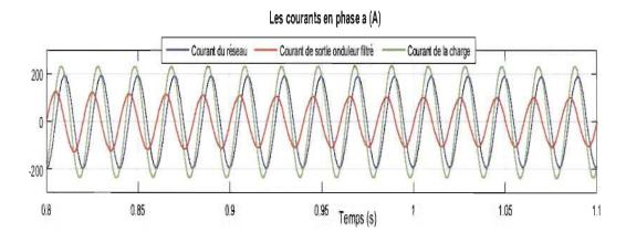
Figure 4.43 Forme des courants de NPC 5-niveaux
