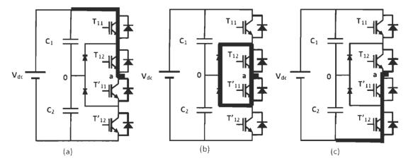
Figure 3.10 : Séquences de fonctionnement d'un bras d'onduleur NPC trois niveaux [30]
