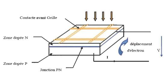
Figure 1.1 Schéma d'une photovoltaïque [5]
