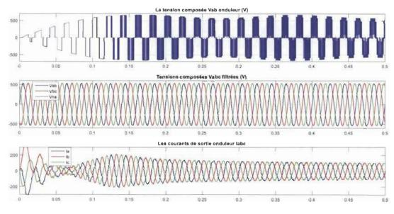
Figure 4.36 Forme des signaux de l'onduleur FC 3-niveaux connecté au réseau
