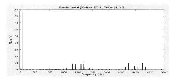
Figure 4.17 : Spectre harmonique la tension  $V_{ab}$  de FC 3-niveaux
