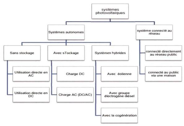
Figure 3.2 Arbre des systèmes photovoltaïques [24]
