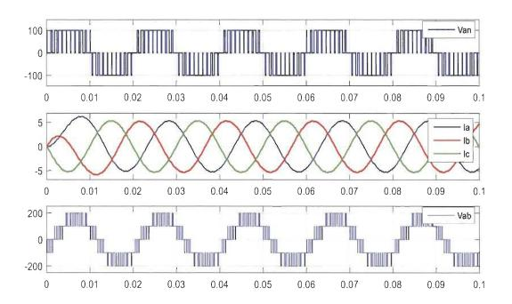
Figure 4.11 Forme des signaux de l'onduleur CHB 3-niveaux
