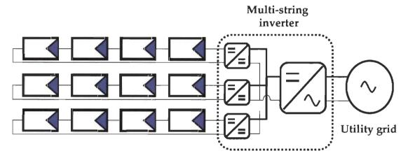
Figure 3.5 Topologie d'onduleur multi-string [26]
