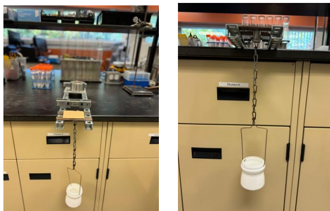
Figure 4.30. Test de mesure maison du tack
