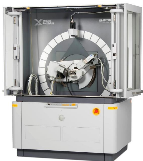
Figure 2.7 Instrument Malvern Panalytical Empyrean 3, pour les mesures de P-XRD.
