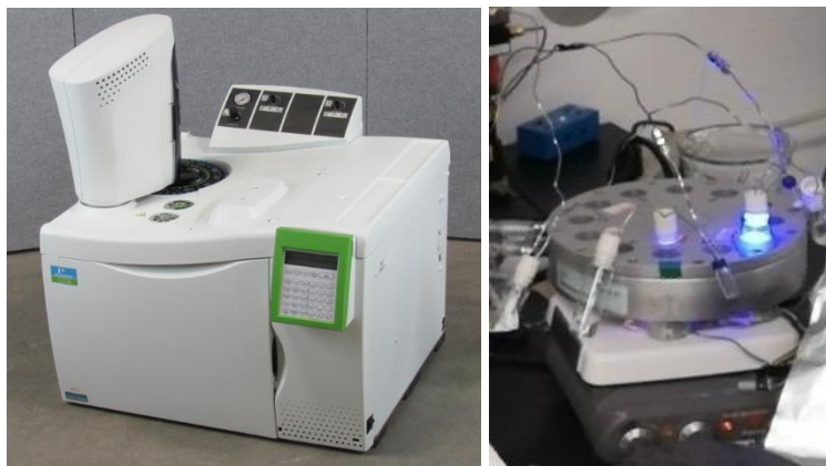
Figure 2.11 Appareil de Chromatographie en phase gazeuse de Clarus 480 PerkinElmer, et du photoréacteur (LED 10 W, 445 nm).
