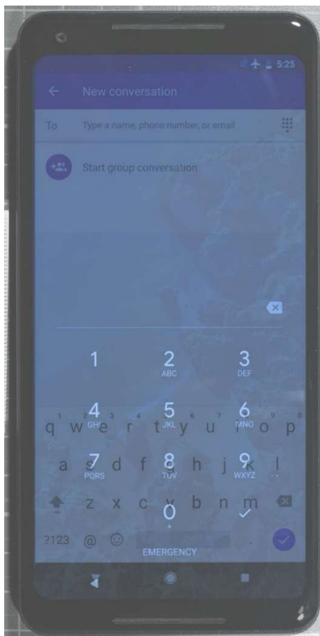
Figure 5.25 - Superposition de l'interface de déverrouillage et de l'interface de conversation, avec le clavier alphabétique
