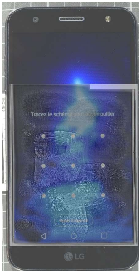
Figure 5.12 - Reconstruction du motif de déverrouillage pour le scénario d'envoi de message texte (LG X Power 2)
