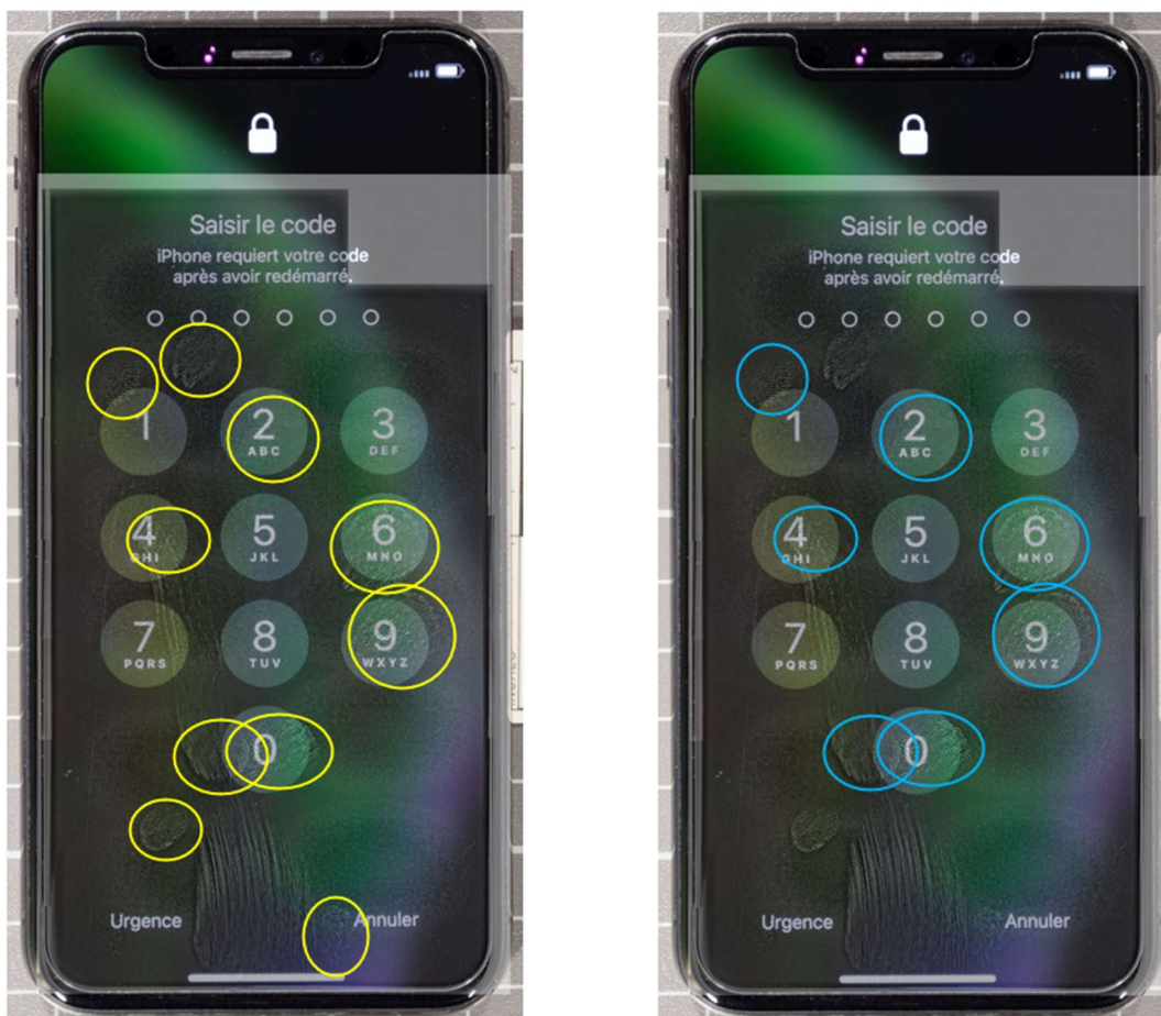
Figure 5.22 - Identification de toutes les traces de forme arrondie (gauche) et des traces susceptibles de faire partie du code (droite) lors de la reconstruction d'un code à six chiffres
