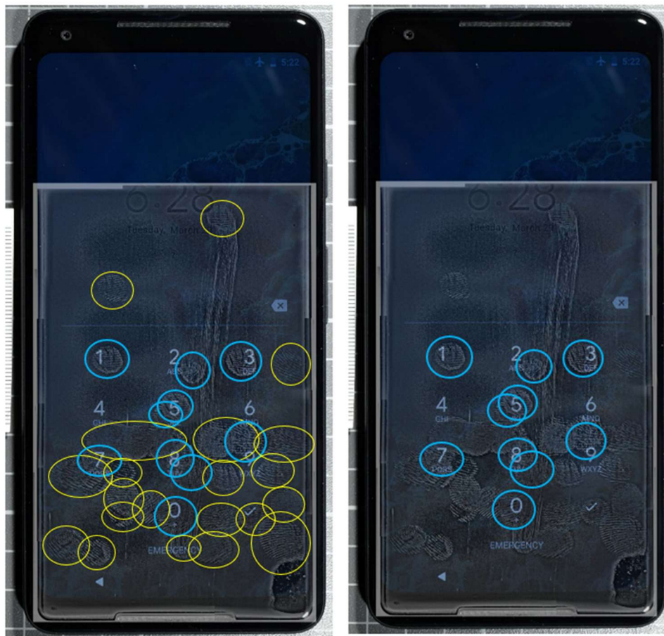
Figure 5.24 - Mise en évidence des traces susceptibles de faire partie du code selon leur position (gauche) et visualisation des traces d'intérêt sans les traces catégorisées comme faisant partie des manipulations subséquentes (droite)
