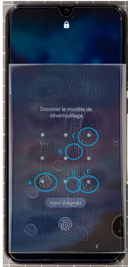
Figure 5.10 - Points d'intersection susceptibles d'être catégorisés en tant que nœuds
