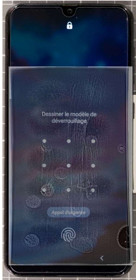
Figure 5.8 - Reconstruction du motif de déverrouillage pour le scénario de navigation sur une application (Samsung Galaxy A50)
