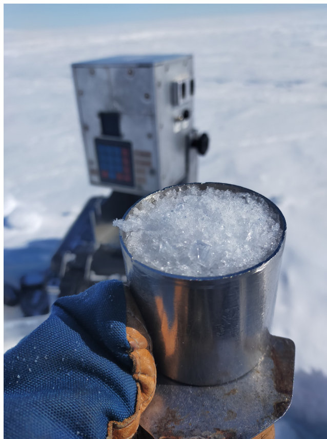
FIGURE 1 – Mesures de SSA avec l'instrument IRIS 2.0 (MONTPETIT et al., 2012 )
