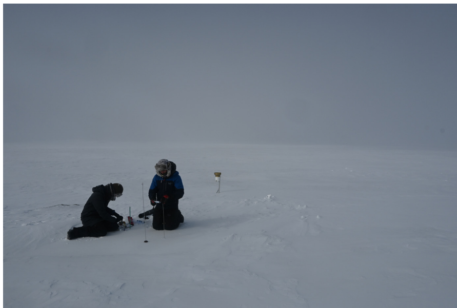
FIGURE 2 – Mesures de gaz à plusieurs profondeurs dans le manteau neigeux (Crédits photo : A. Roy)
