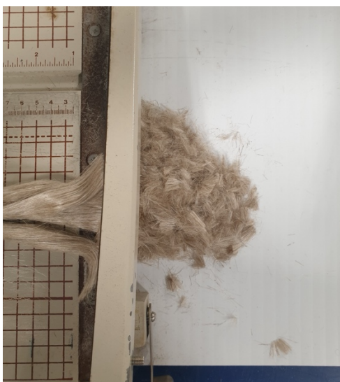
Figure 3.8 Découpe des fibres de lin.
