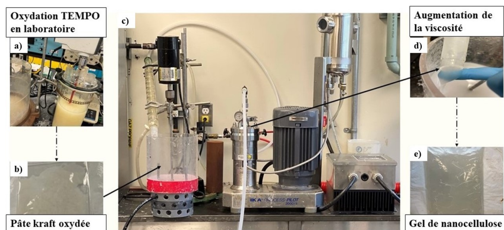
Figure 3.12 Procédé pour la préparation de nanocellulose.
