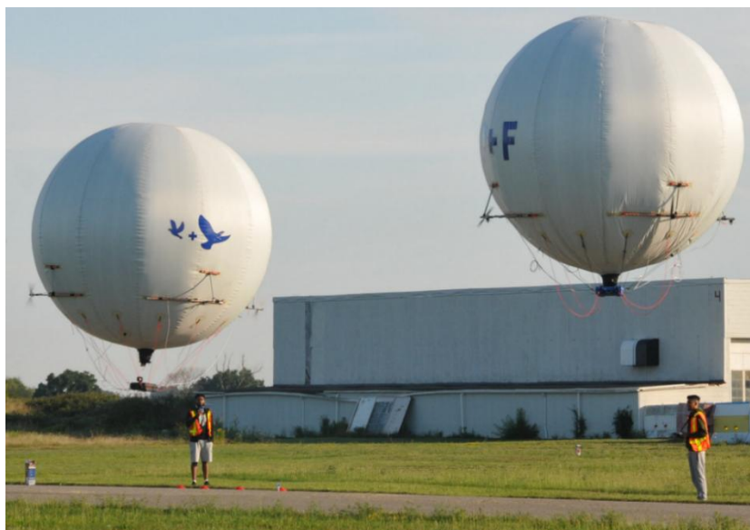
Figure I. 3 Vol d'essai du dirigeable TS3 avec de l'hélium comme gaz de sustentation
