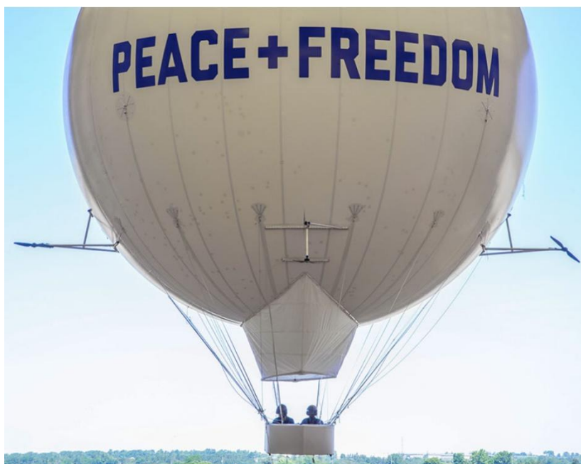
Figure I. 4 Vol d'essai du dirigeable TS11 avec de l'hélium comme gaz de sustentation à l'aéroport municipal de Brantford
