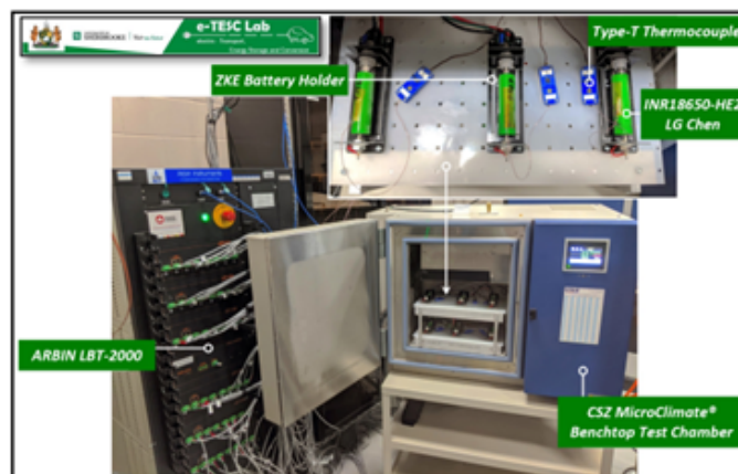
FIGURE 2-8 Configuration du test de batterie.
