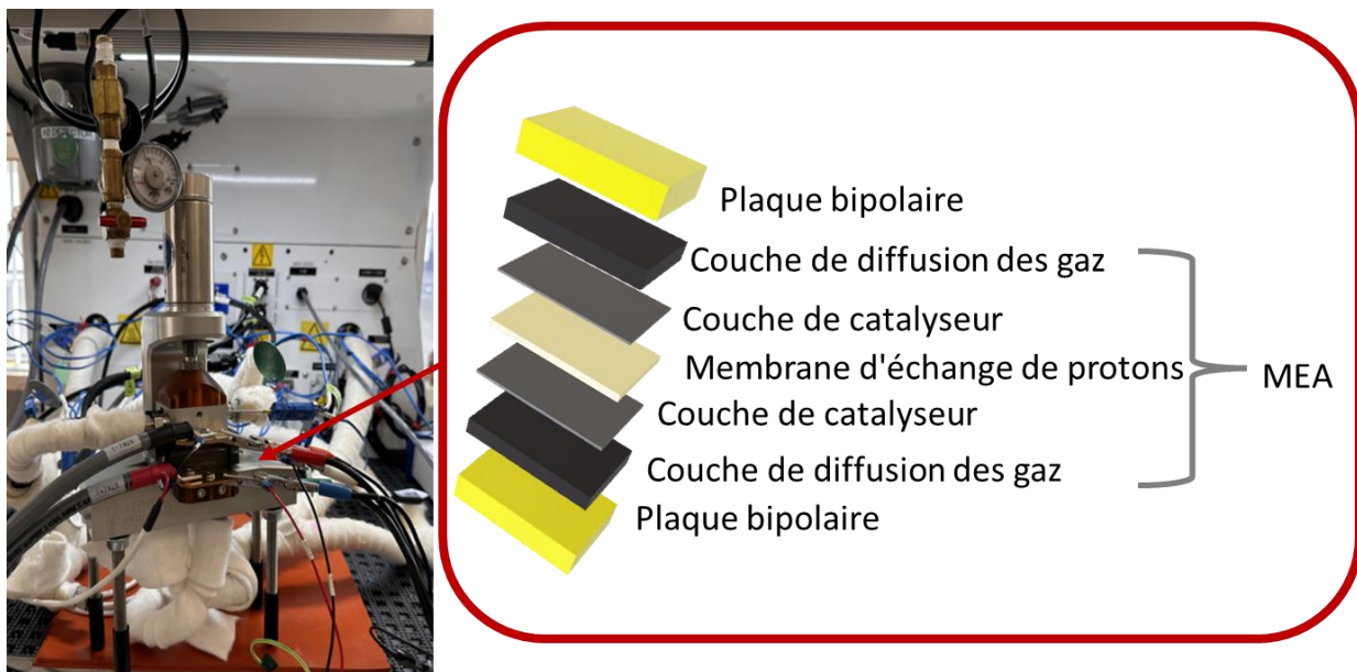
Figure 3.1 Système de test de pile à combustible en utilisant l'ensemble d'électrodes à membrane (MEA) avec membrane échangeuse de protons et démonstration de ses composants.
