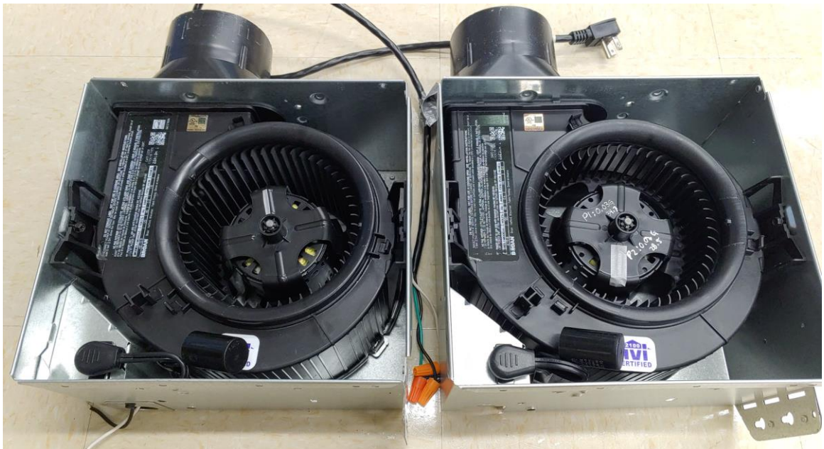
Figure 90: Comparaison entre les roues de l'AE110 et l'A110
