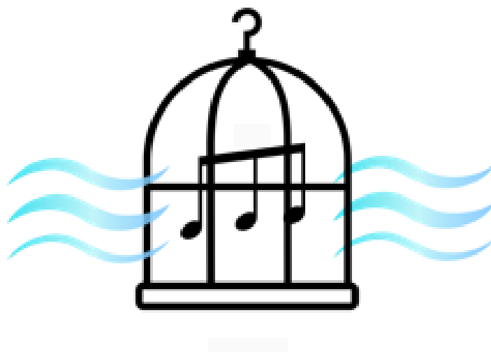
Figure 2: Concept de la métacage : emprisonne la source acoustique mais laisse libre cour au débit d'air
