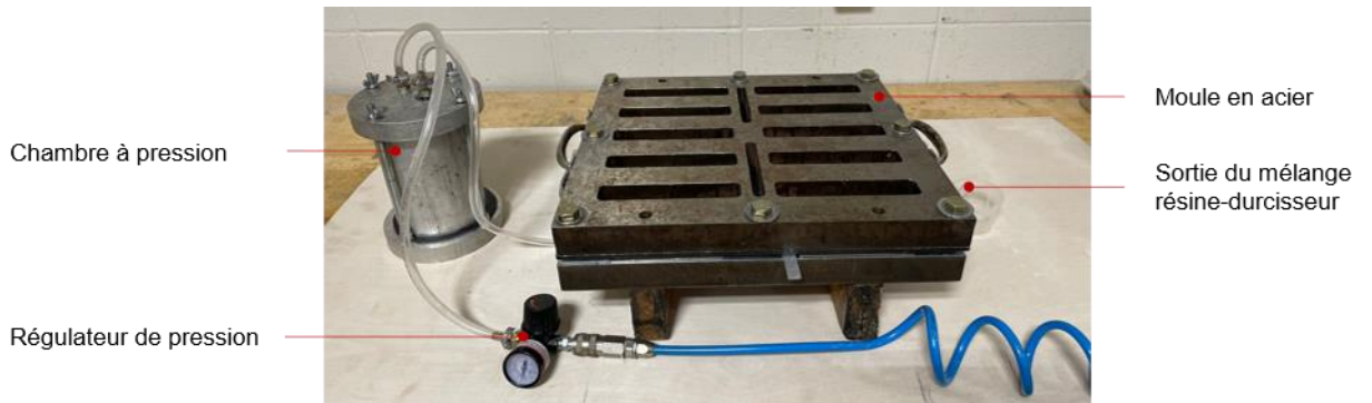
Figure 2.5 – Montage de moulage par RTM des composites à l'UQTR.
