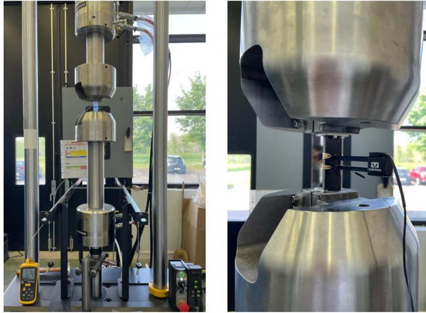
Figure 2.9 – Dispositif des essais de fatigue et de traction avec (a) la machine servo-hydraulique Instron 8801 munie d’une cellule de 100 kN et (b) une éprouvette lin/époxy munie d’un extensomètre de 12,5 mm de longueur de jauge.
