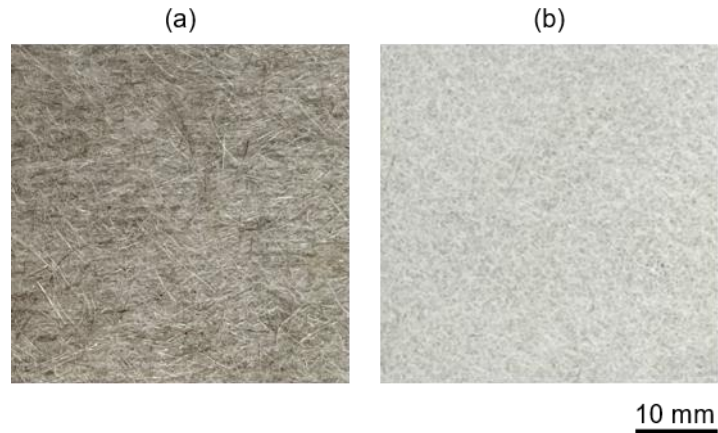
Figure 2.3 – Mats de fibres courtes : (a) non-fibrillées et (b) fibrillées.
