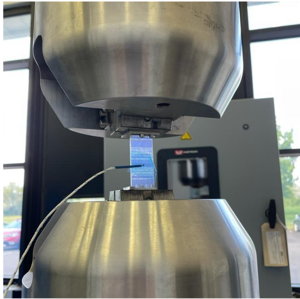
Figure 2.14 – Mesure de la température d’une éprouvette VUD0 à l’aide d’un thermocouple.
