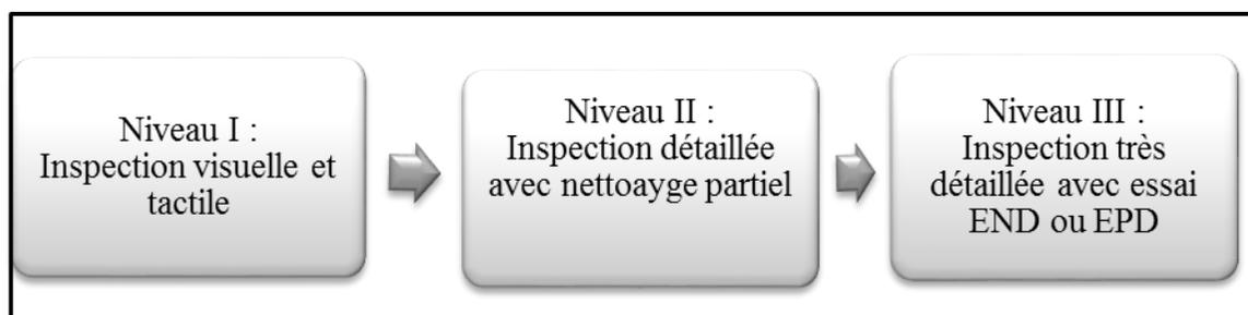
Figure 1-15 Niveaux d'inspection sous-marine ([Browne et al., 2010](#))
