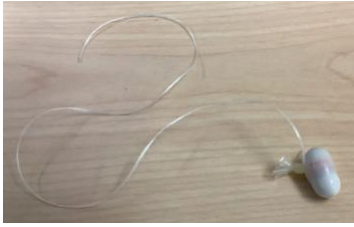
Figure 6. Sonde rectale téléométrique thermométrique.
