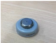
Figure 8. Capteur iButtons Hygrochron inséré dans une capsule de plastique qui permet de maintenir le capteur à quelques millimètres de la peau pour mesurer la température et le taux d'humidité relative dans l'équipement de protection individuelle.
