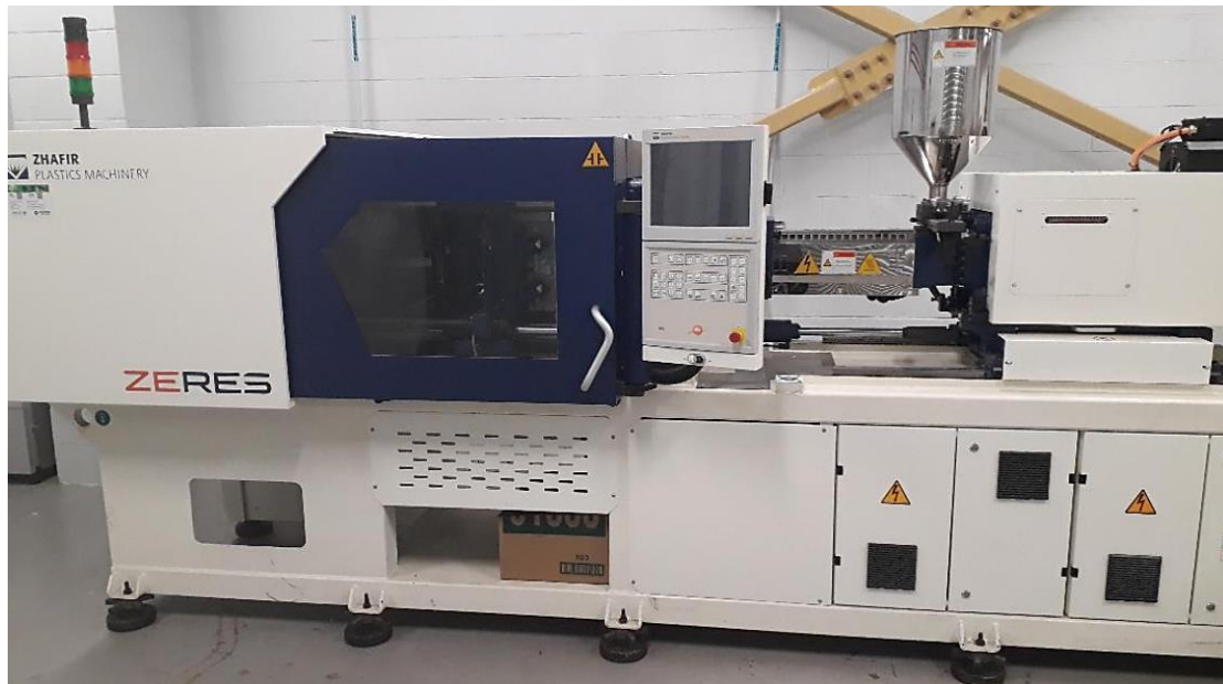
Figure3. 1. Procédé du moulage par injection des éprouvettes en bio-composites.
