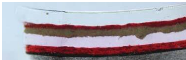
Figure 2.4. Coupe microtomique de réparations après la mise en circulation au-dessus des couches OEM (grossissement : ~ 280x) (Weimer et al., 2020).
