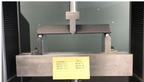
Figure 3.21 Montage d'un essai de flexion trois-points.
