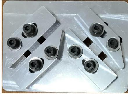
Figure 3.18 Dispositif de fixation des extrémités d'une cornière.
