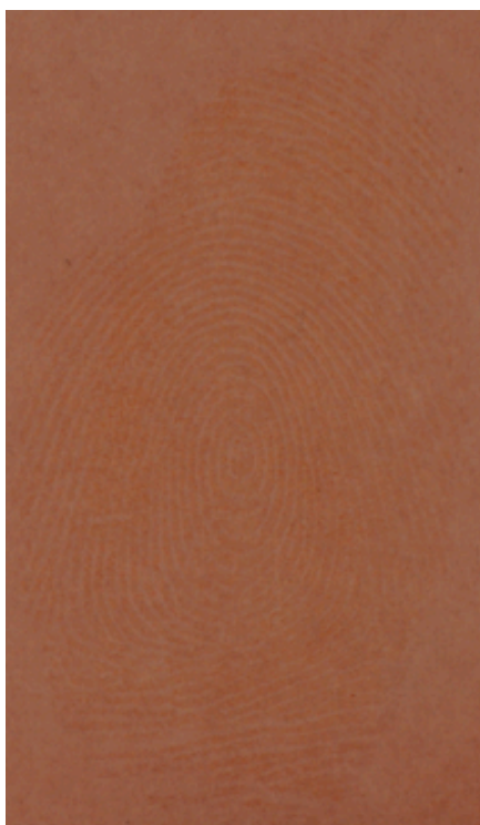
Figure 4.7 Révélations obtenues à l'aide de l'analogue 50 dans 50 mL de méthanol avec ajout de 20 mL d'eau.
