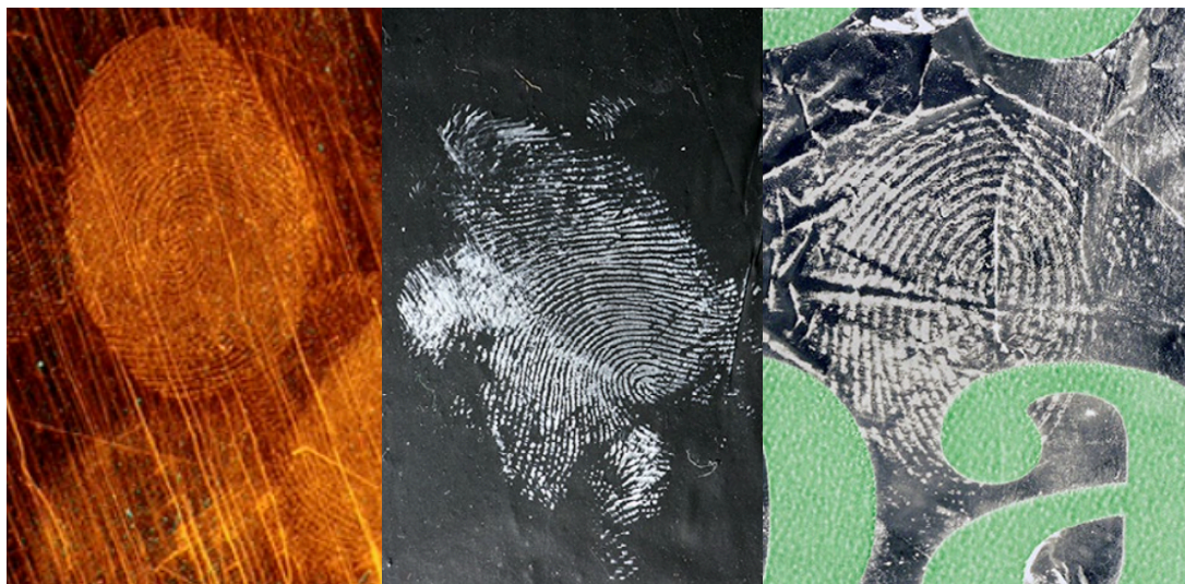
Figure 2.1 Exemple de révélations obtenues par la technique de poudre dactyloscopiques fluorescentes (gauche), Cyanoacrylate (centre) et VMD (droite) (Bandey et al. , 2014, p. 639, 719).
