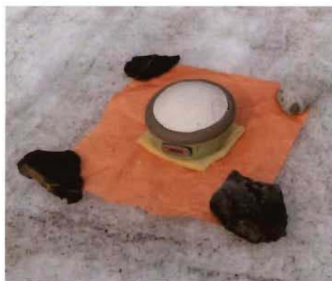
Figure 2.3 Cible utilisée comme GCP, avec récepteur GNSS.
