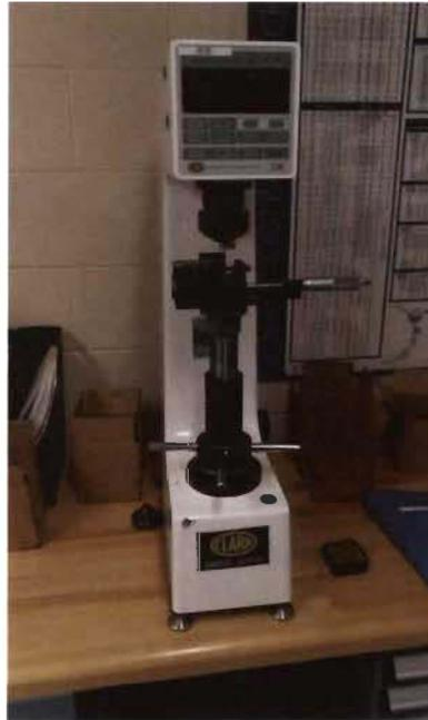
Figure 2.3: Appareil de mesure de dureté
