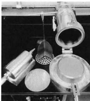
Figure 3.5 Formette et outils pour la formation des feuilles
