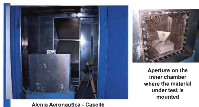
FIG. 4.3 – Méthode de la chambre réverbérante [3].
