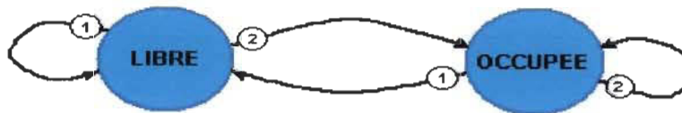
Figure 3.17 : Machine d'état de commande de la fermeture d'une cible par le maître
