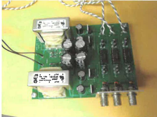
Figure E-2 Carte d'amplificateur d'isolation conçue pour la commande de la source programmable.
