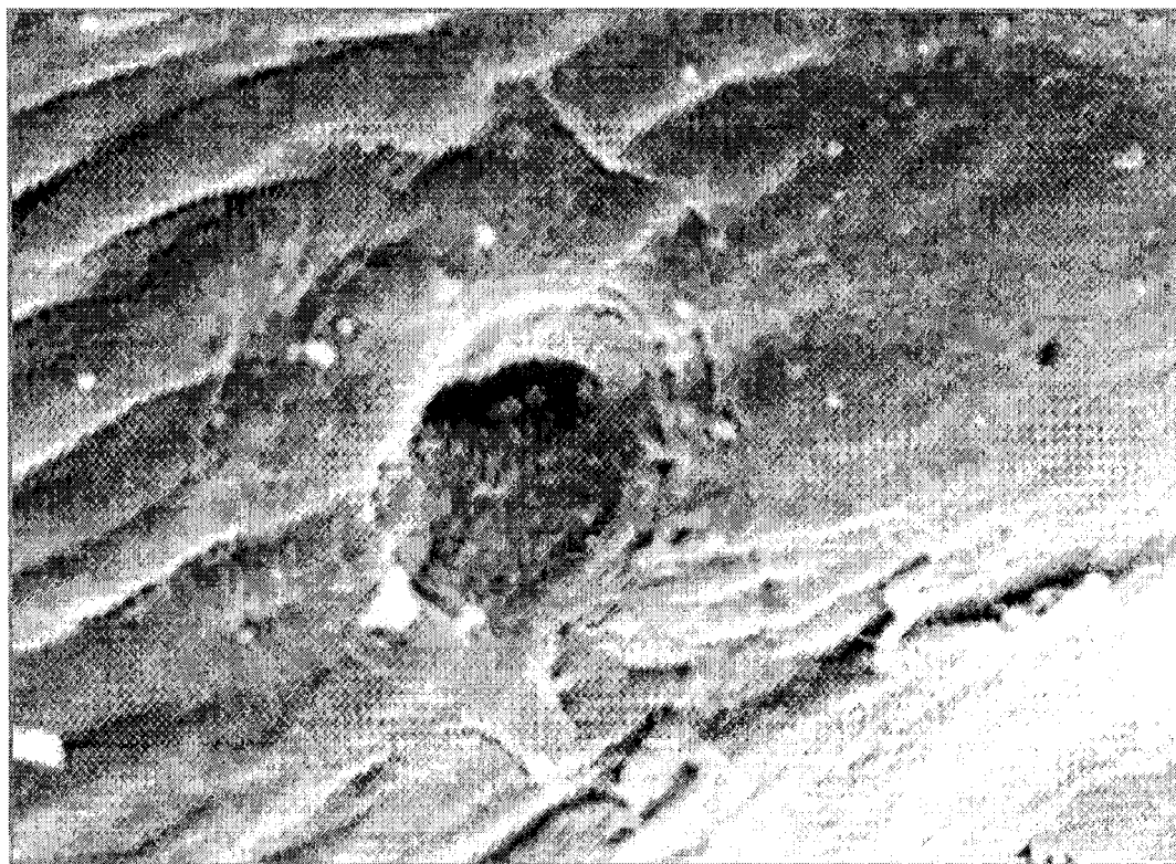
Figure 2.10 Petites particules d'encre incorporés dans le lumen
