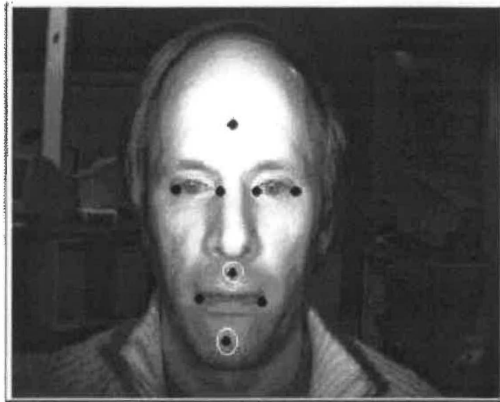
Figure 3.10: Les neuf points faciaux utilisés pour l'enregistrement, les deux cercles en blanc montrent les deux points non importants pour découvrir l'origine de mouvement (activation d'une unité d'action ou mouvement de tête non rigide).
