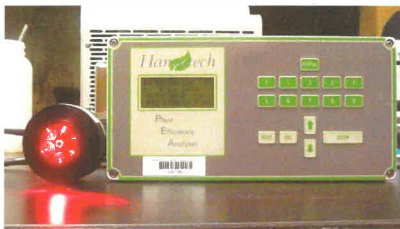
Figure 2.2 Illustration du Plant Efficiency analyser de Hansatech. Dans cette illustration, la sonde est en mode émission/lecture et on y aperçoit une lumière rouge de forte intensité
