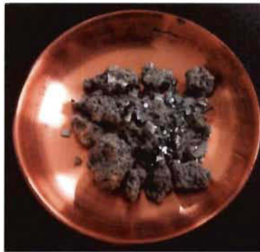
Figure 2.2 : Photographie du creuset de cuivre, avec les composés prêts à synthétiser
