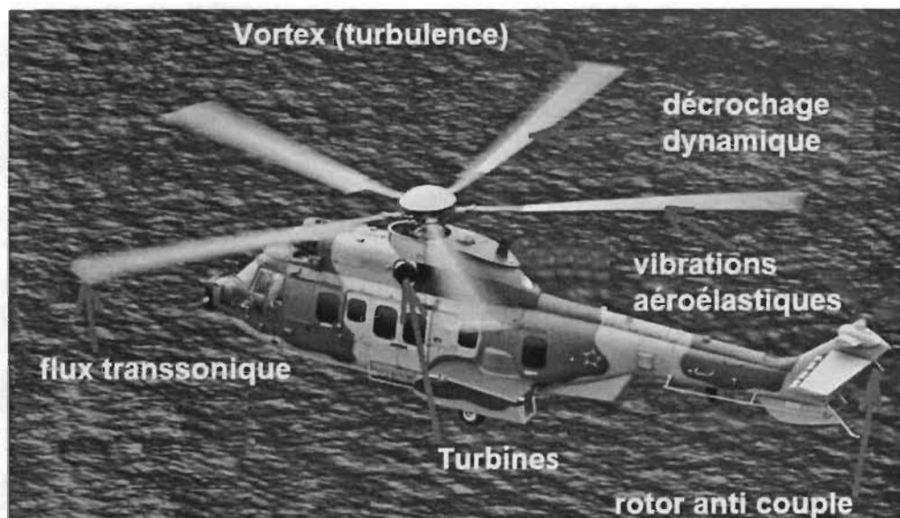
Figure 5. Éléments générateurs de bruit dans les hélicoptères classiques.
