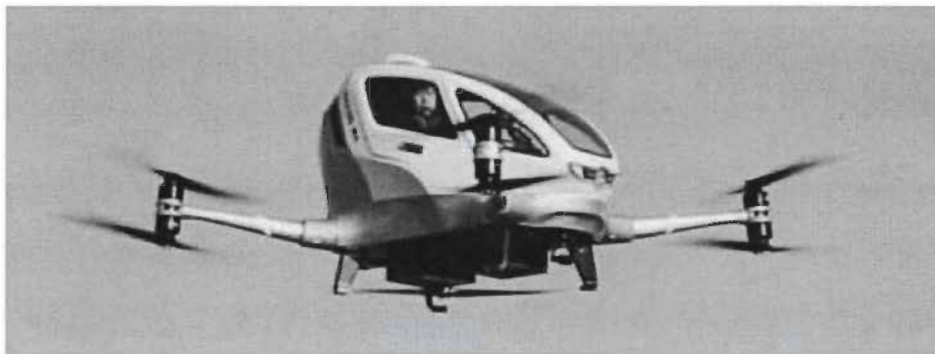
Figure 7. Ehang 184 multicopter. (une conception eVTOL de complexité relativement faible) (crédits d'image: Ehang)
