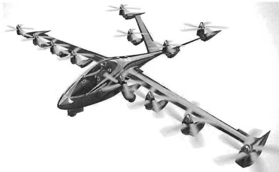
Figure 9. Le Joby S4 (rotors basculants). (crédits d'image: Joby Aviation)
