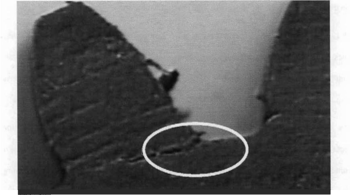
Figure II-1. Exemple de bris par fatigue à la racine (Sentbilvelan and Gnanamoorthy 2004).
