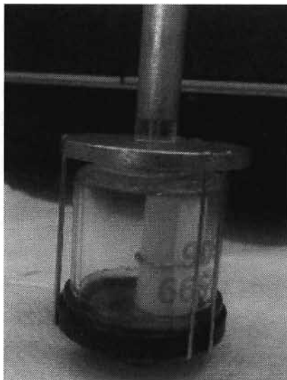
Figure 4-3 Photo d'un pénétromètre contenant l'échantillon
