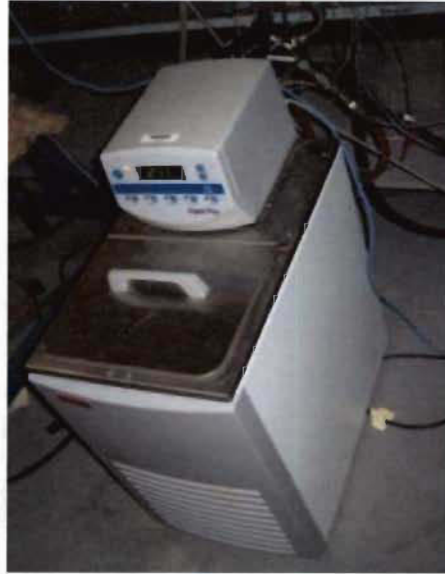
Figure 4-4 Bain thermostatique pour le contrôle thermique de la PAC
