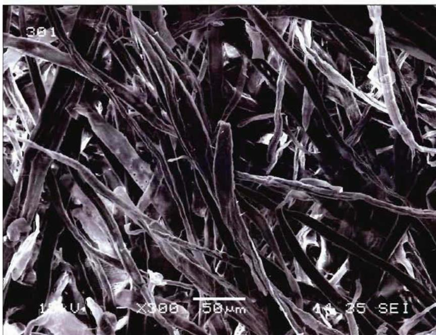
Figure 4.10 Microscopie électronique à balayage de la pâte oxydée et recyclée une fois.
