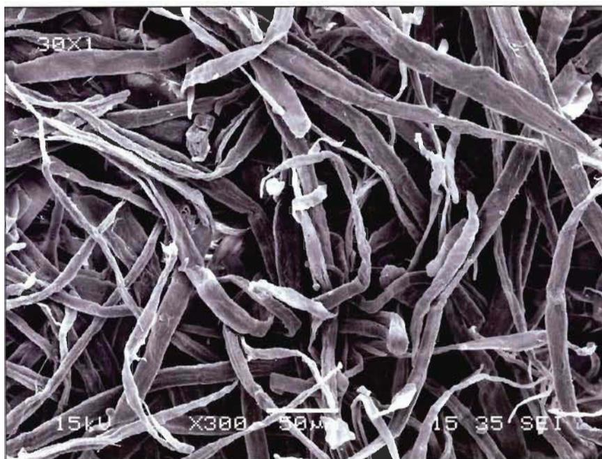
Figure 4.9 Microscopie électronique à balayage de la pâte chimique vierge oxydée.
