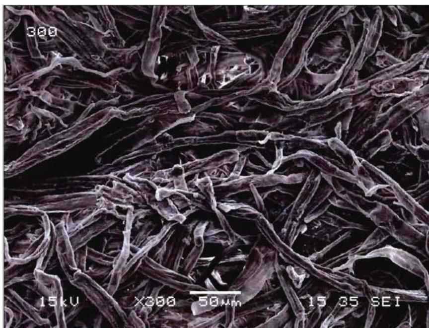
Figure 4.8 Microscopie électronique à balayage de la pâte originale.
