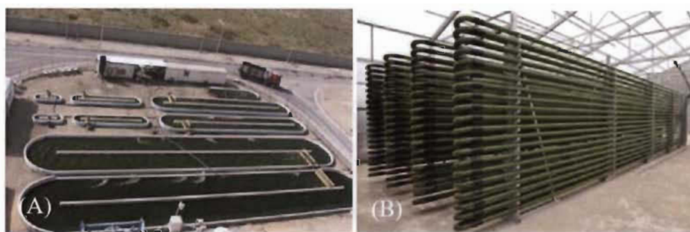
Figure 1.3 Principales méthodes de culture à grande échelle des microalgues : en bassins ouverts (A) et en photobioréacteurs tubulaires (B) [6].
